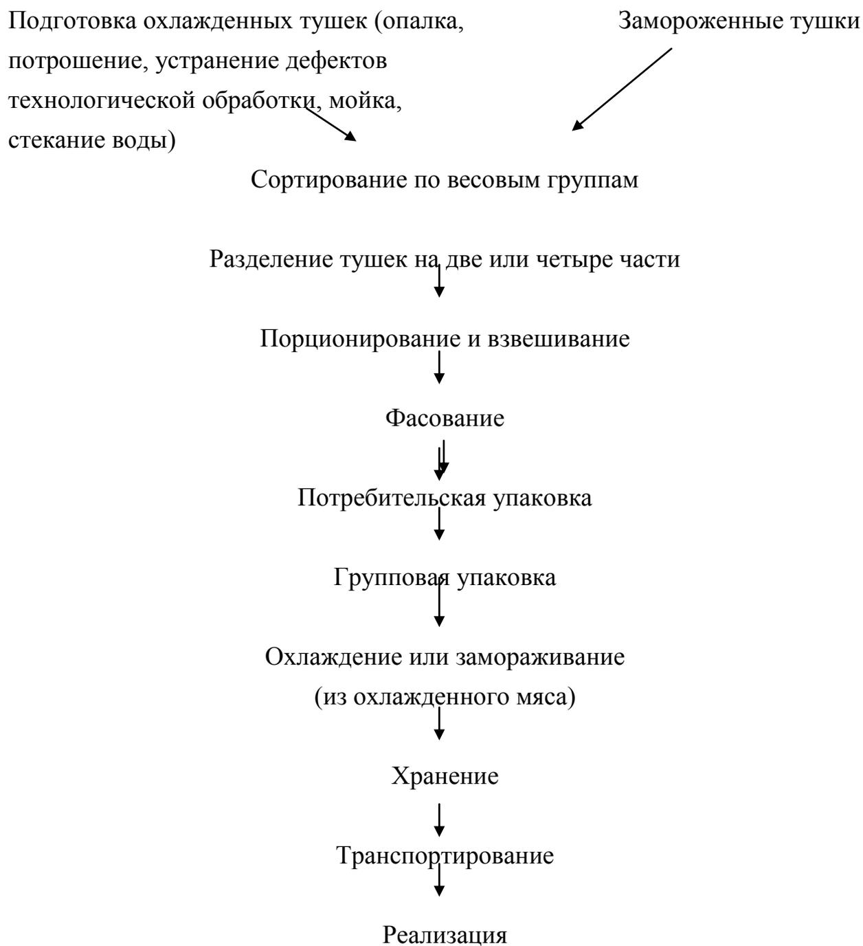
Рис. 2.26. Технологическая схема производства фасованного мяса птицы
