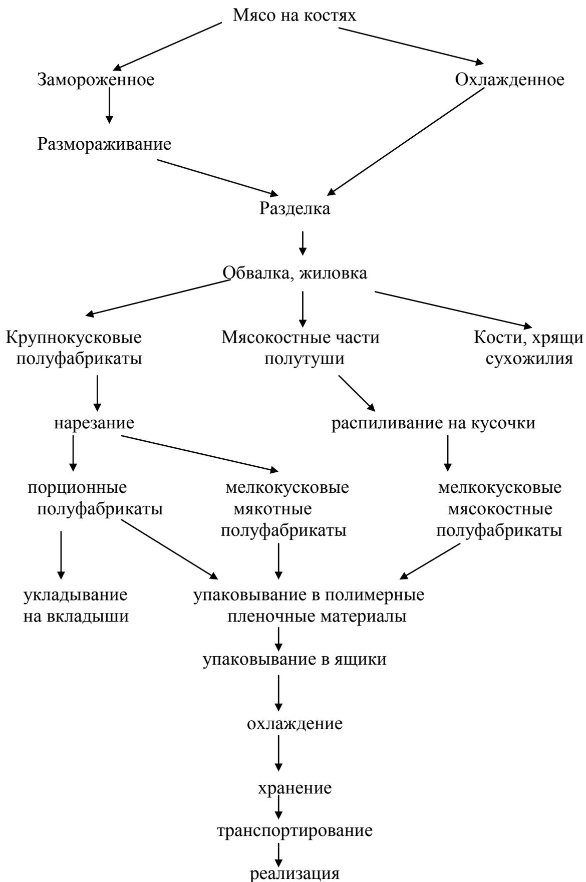
Рис. 2.18. Технологическая схема производства порционных и мелкокусковых полуфабрикатов
