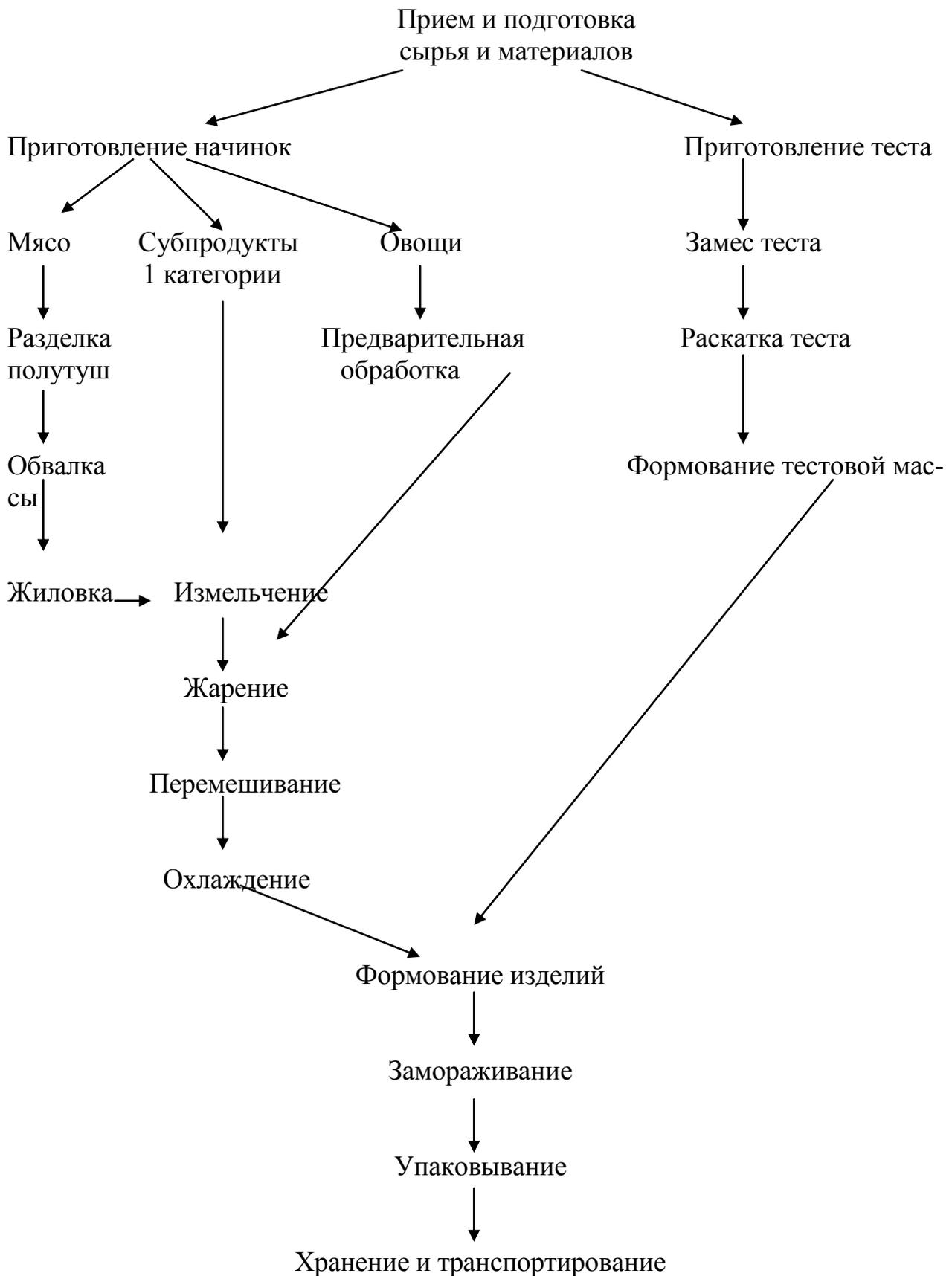
Рис. 2.34. Технологическая схема производства быстрозамороженных изделий из теста
